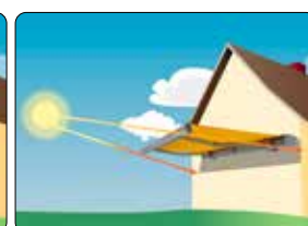
Soleil bas par ex. façade orientée ouest
